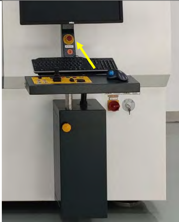
设备控制台上紧急停止按钮
